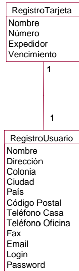
Figura 6.38 Diagrama de clases para el módulo de Registro del sistema de reservaciones de vuelo.
