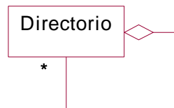
Figura 4.89. Diagrama de clases para un ensamblado recursivo describiendo un Directorio que puede contener otros varios Directorios de forma recursiva.
