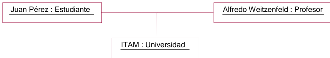
Figura 4.36. Diagrama de instancias describiendo una relación ternaria entre objetos de tipo Estudiante , Profesor y Universidad .
