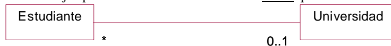
Figura 4.47. Diagrama de clases describiendo una multiplicidad de "opcional-muchos" entre Estudiantes y Universidad .
