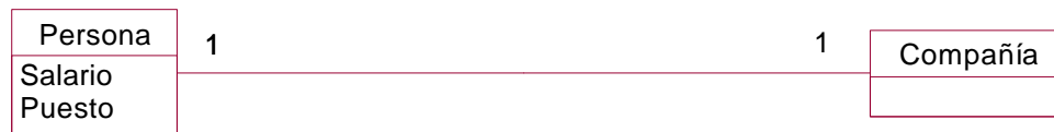
Figura 4.72. Diagrama de clases para Persona y Compañía conteniendo multiplicidad "uno-uno" y los atributos de asociación salario y puesto incluidos directamente en la clase Persona (o de forma alterna en la clase Compañía ).
