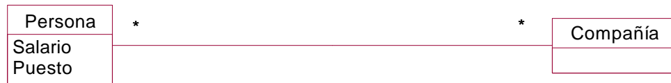
Figura 4.74. Diagrama de clases incorrecto para Persona y Compañía conteniendo los atributos de asociación salario y puesto incluidos directamente en la clase Persona .
