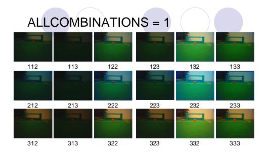
Analizando las fotos se decide qué filtro usar. Lo que sigue es cambiar el parámetro de '1' a '2' y tomar fotos de puntos de interés, como las porterías, postes, pelota y otros robots. Éstas fotos se abren con el programa EKCalibration y se realiza la segmentación.
