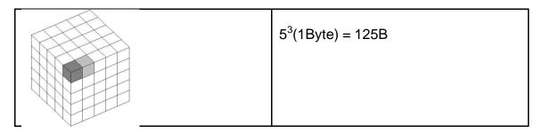
Con 256 tendríamos  $256^3(1 \text{Byte}) = 16 \text{MB}$  lo cual es demasiado, dado que es la capacidad total de la memory stick que utiliza el Aibo. Entonces utilizamos 128, con lo que se obtiene  $128^3(1 \text{Byte}) = 2 \text{MB}$ .
