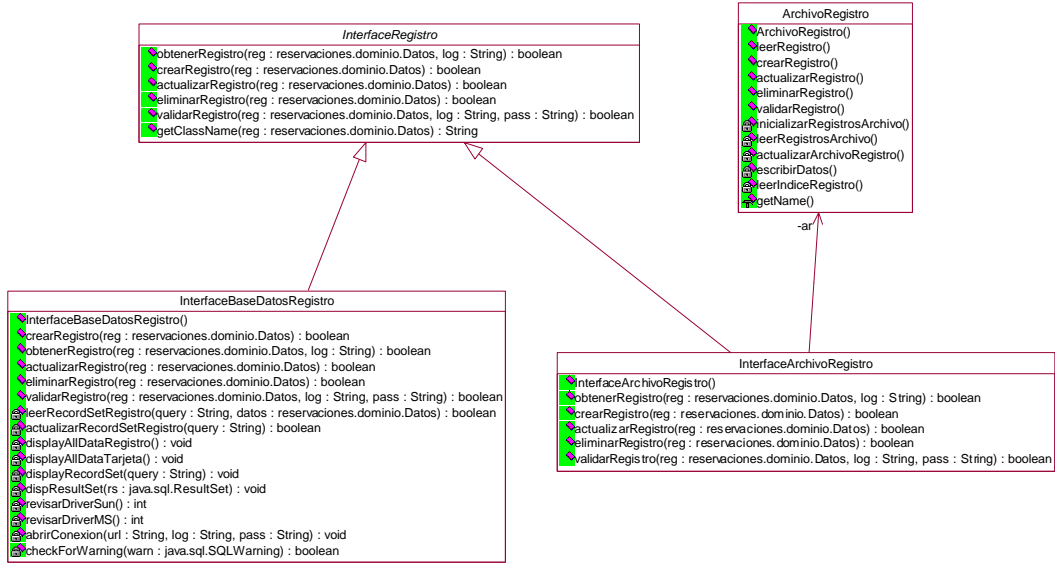
Figura 10. Diagrama de clases para el módulo InterfaceBD .
